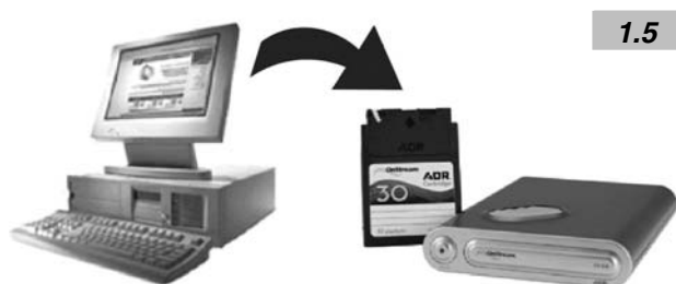
Säkerhetskopiering av den information som finns i persondatorn till en bandstation.
